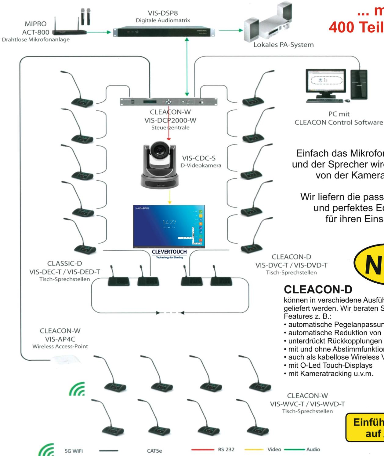
Einfach das Mikrofon einschalten und der Sprecher wird automatisch von der Kamera erfasst.
