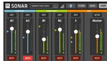
Due SONAR Xi nel modo Stereo: Comuni fader per il canale 3 e il volume Master
