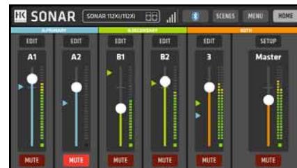
Zwei SONAR Xi im Stereo-Mode: Kanal 3 und Master-Volume werden gemeinsam geregelt
