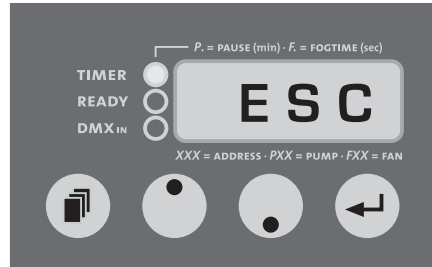
Escape zum Wechseln ins Standard-Menü mit Enter-Taste
