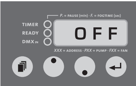
Abb. 3: Display-Anzeige beim Ausschalten des Gerätes
