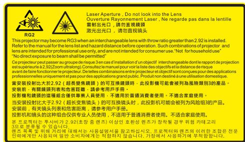
Dieser Projektor kann als Produkt der Risikogruppe 3 zugeordnet werden, wenn ein Wechselobjektiv mit einem Projektionsverhältnis größer 2,92 installiert wird. Beachten Sie die Anleitung für das Objektivverzeichnis und den Gefahrenabstand vor dem Betrieb. Solche Kombinationen von Projektor und Objektiv dienen nur der professionellen Verwendung und sind nicht für den Privatgebrauch vorgesehen. Nicht für den privaten Hausgebrauch.
