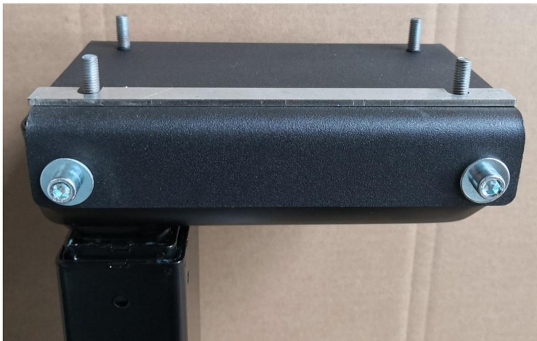
Um zu vermeiden, dass nach vollendeter Montage des Systems mit Seitenflügeln die Flügel selbstständig aufklappen, sind wie im Bild gezeigt, die entsprechenden, beiliegenden Unterleger an der Vorderseite zwischen Motor und Displayaufnahme zu positionieren.
